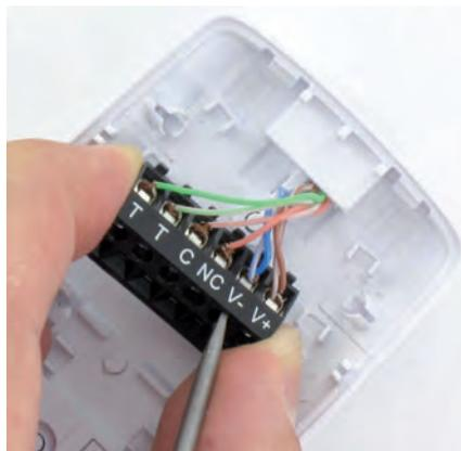
**Conexión sencilla:** se puede desenchufar el conector para facilitar el proceso de cableado.
