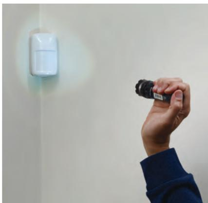
**Activación del test de paseo:** permite activar el test de paseo enfocando un haz de luz blanca hacia el detector, reduciendo el número de viajes al sensor durante la instalación.
