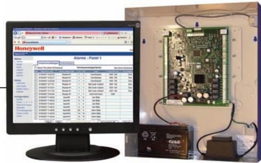
El controlador NetAXS de Honeywell es una solución de control de acceso con gran cantidad de funciones y una interfaz Web intuitiva. NetAXS ofrece todas las ventajas de los controles de acceso tradicionales, como ayudar a asegurar las puertas, gestionar el acceso de empleados a las instalaciones de forma remota, y generar informes fácilmente para cumplir con los requisitos de conformidad.
