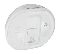
Quando è attivo l'allarme, la pressione del pulsante permette di tacitare il segnale acustico per un periodo di 4 minuti. Se la concentrazione di monossido di carbonio è superiore a 150 ppm, l'allarme non verrà comunque tacitato.
