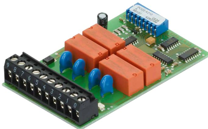
Le module comprend 4 relais avec contacts repos pour tension continue et alternative jusqu'à 2 A, 250 VCA. Les contacts sont protégés par une varistance. Le module convient tout particulièrement lorsque des circuits de courant alternatif entièrement séparés avec une fréquence de commutation faible doivent être contrôlés.
