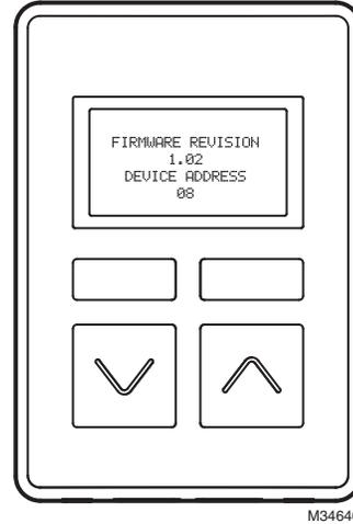
Fig. 10. TR42 Wall Module LCD display startup screen 2.
