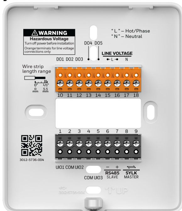
Fig. 11. Atribuição dos terminais do termostato
