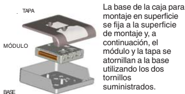
FIGURE 3: CONEXIONES DE LOS MÓDULOS M710 DE ENTRADA ÚNICA Y M720 DE ENTRADA DOBLE
