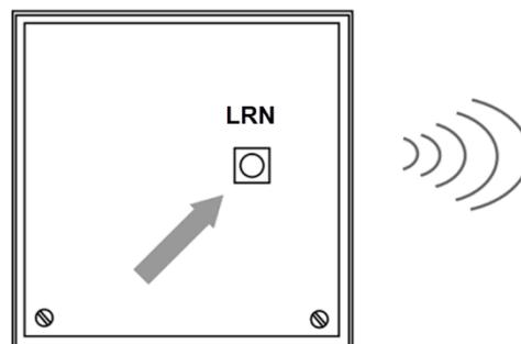
oder manuell durch Eingabe der 32bit Sensor-ID und einer speziellen „Einlernprozedur“ zwischen Sender und Empfänger. Details werden in der jeweiligen Softwaredokumentation des Empfängers beschrieben.
