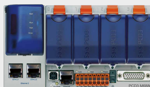
Ethernet 2 (2 porte switch)
