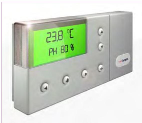
Dieses Raumbediengerät zeichnet sich durch sein grafikfähiges Display mit 128x64 Pixel (8x20 Zeichen) und die LED Hintergrundbeleuchtung aus. Die sechs integrierten Tasten ermöglichen eine individuelle Anpassung aller notwendigen Raumparameter. Des Weiteren wurden Temperatur- und Feuchtesensoren integriert, damit der angeschlossene Controller direkt Einfluss auf das Raumklima nehmen kann.
