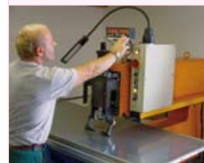
Blecbearbeitung der Montageplatten mit hydraulischer Stanze und CNC-Vermessung
