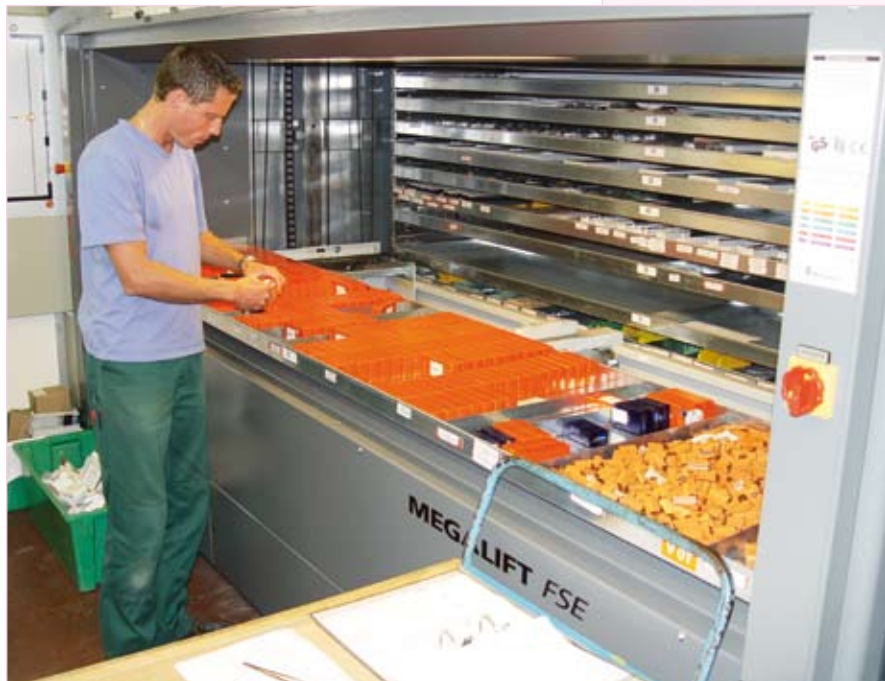
Verwaltung von Saia®-Komponenten im automatischen Regalsystem
