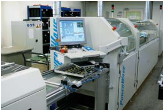
Neue Wellenlötmaschine für den bleifreien Lötprozess
