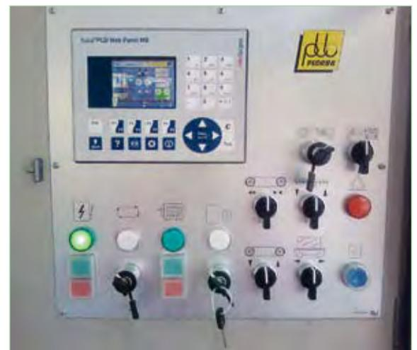
Die Bediener-Schnittstelle der neuen Maschine mit dem 3.5" Saia®PCD Web-Panel im Zentrum
