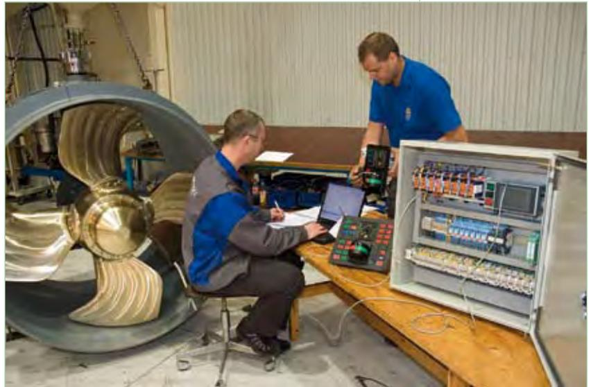
das Schiff gesteuert wird, immer in der aktuellen Position stehen, d.h. die Handles sollen entsprechend der manuellen Bedienung nachgeführt werden. Als Prototypen wurden Handles von Brunvoll mit Saia®Schrittmotoren ausgerüstet, die wiederum von einer weiteren Saia®PCD3 angesteuert werden. Das Konzept befindet sich derzeit in der Testphase.
