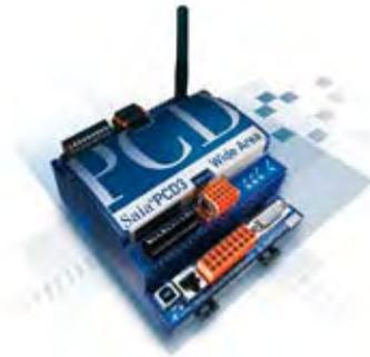
bereits einige Ein- und Ausgänge direkt im Basisgerät integriert. Es sind dies 10 digitale Eingänge, 4 konfigurierbare analoge Eingänge sowie 2 Relaisausgänge. Und falls dies nicht reicht oder passt,
