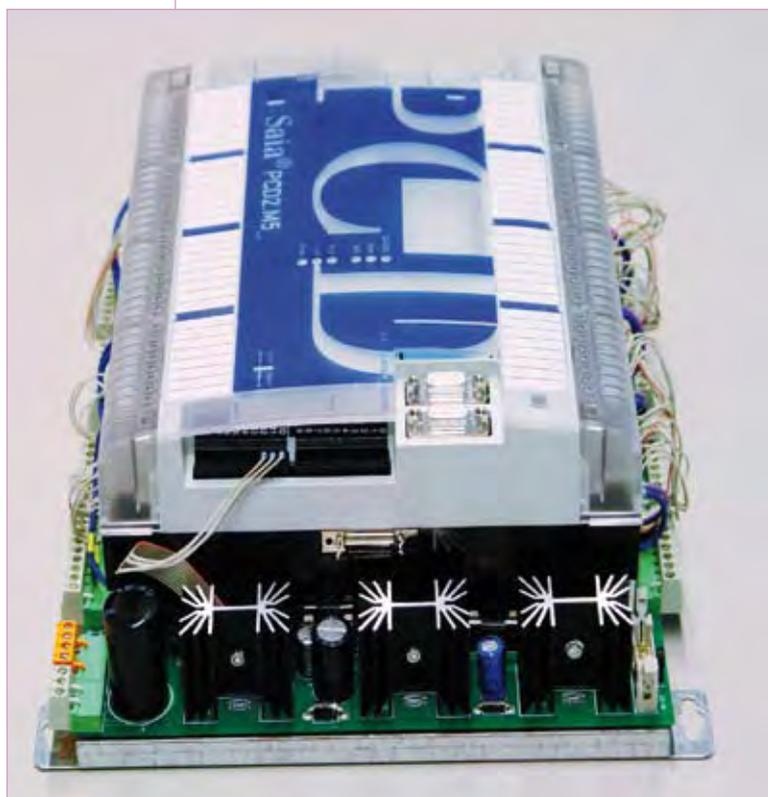
Um diese Problematik in den Griff zu bekommen, wurde ein Staefa Integral TS 1500 Adapterboard entwickelt, welches bei Ersatzbedarf schnell und ohne Schaltschrank-Umbau eingesetzt werden kann. Da das Adapterboard mit einer PCD2.M150
