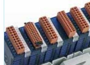
Par une modification des moules, tous les modules E/S PCD3 peuvent être équipés d'un clip de marquage. On peut se procurer ces clips comme accessoires, modèles d'étiquette compris.
