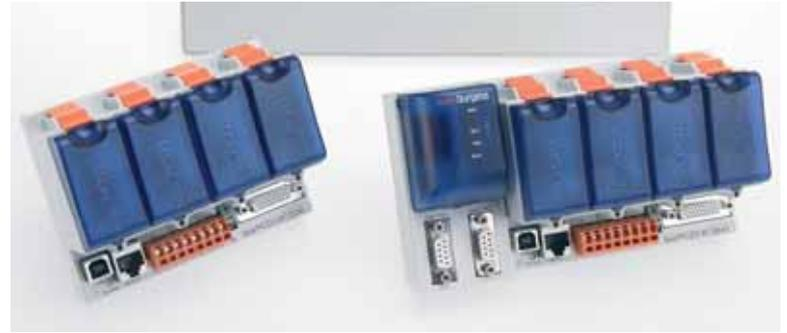
emplacements entrées/sorties. Pour une utilisation comme commande centrale, des extensions sont possibles jusqu'à 1024 entrées/sorties locales. L'automate a une mémoire d'une capacité allant de 128 ko à 2 Mo avec en plus une option pour des modules mémoire du type SD-Flash.
