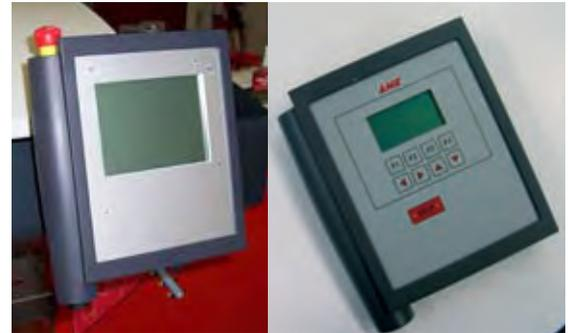
HMI in versione comfort basato su Saia®Web panel MB      HMI in versione semplice basato su Saia®PCD7.D231
