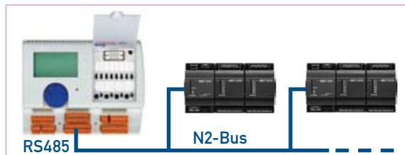
L'integrazione in una rete Bus JCI - N2-Bus può avvenire attraverso un'interfaccia RS 485, che è normalmente integrata in ogni PCD/PCS. Dopo la configurazione del driver, il sistema di automazione Saia® opera come una normale stazione N2-Bus per scambiare dati specifici dell'impianto.
