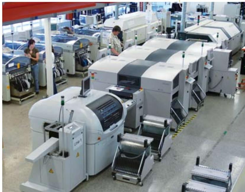
Produzione SMD di Saia-Burgess Controls ampliata con tre nuove macchine SMD
