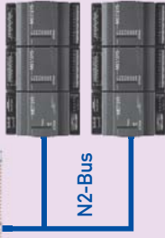
Saia®PCD2.M5控制器作为主站连接到JCI从站设备
