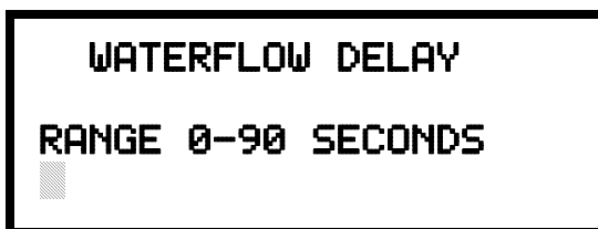
Pantalla Retraso de caudal de agua
