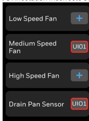
Figure 76 Affectation incorrecte des bornes
