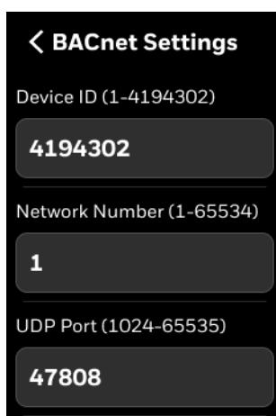
Figura 124 Configuración de red de BACnet IP
