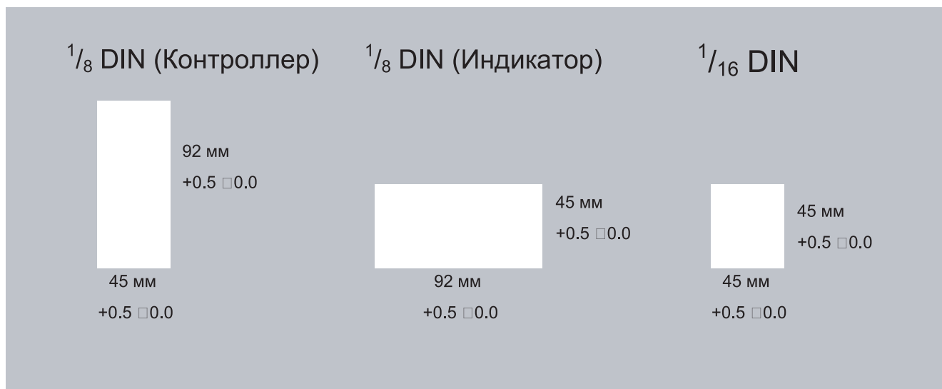
Рисунок 2. Размеры вырезов панели
