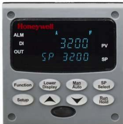
Рис. 2 – Лицевая панель контроллера UDC3200
