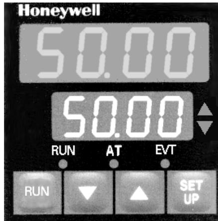
Светодиод RUN индицирует, что программатор находится в режиме RUN
