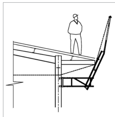
3 Mellomstolpe med stropffeste og konsollbjelke.
