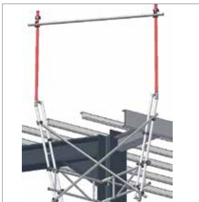
1 Utvendig hjørne med avstiverrør og topprør
