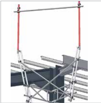
1 Utvändigt hörn med stag och överliggare
