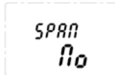
12. Wenn eine Bereichskalibrierung erforderlich ist, ✓ aktivieren, um mit dem nächsten Schritt fortzufahren. Ist keine Bereichskalibrierung erforderlich, mit ▲▼ die Option „No“ auswählen und ✓ aktivieren, um zum Konfigurationsmodus zurückzukehren.
