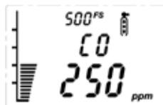
**Hinweis: Bei diesem Beispiel wird für den gesamten Kalibriervorgang von 250 ppm Kalibrierungsgas für einen Bereich von 0-500 ppm CO ausgegangen.**
