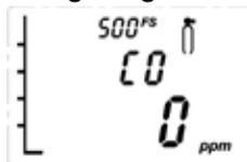
6. Der Nullmesswert am Display des XCD RTD beobachten. Wenn ein stabiler Messwert um „0“ herum angezeigt wird, ist keine Justierung der Hardware erforderlich. Den nächsten Schritt überspringen.
