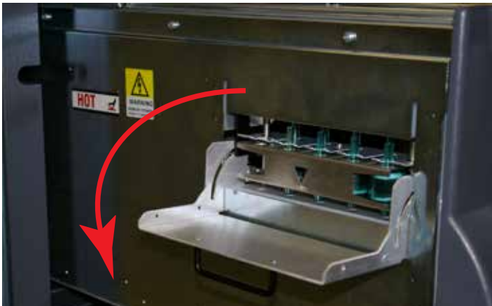
Abbildung 5-5. Filtertür des Pyrolyzers
