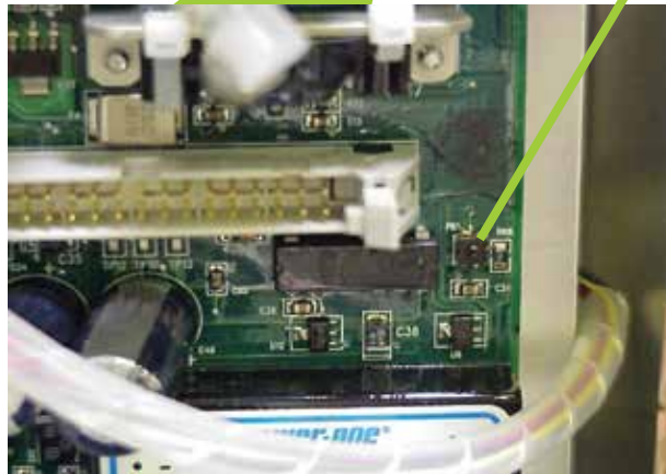
Abbildung 6-1. Einbaulage der Taste für manuelle Übersteuerung des Vertex M-Analyzers
