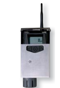
Boîtier de protection en acier inoxydable pour MeshGuard
