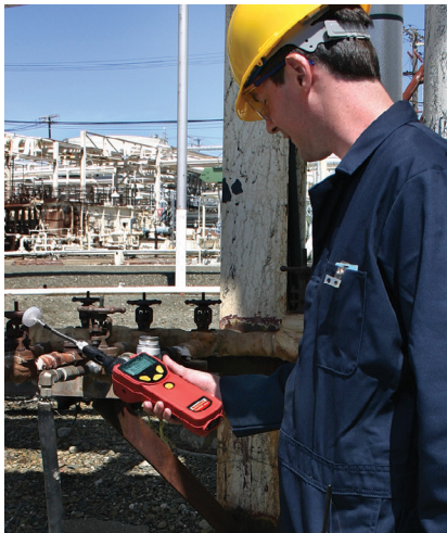
Mit dem RAE Systems UltraRAE 3000+ erhalten Arbeiter VOC-Messwerte überall im Werk schnell und einfach
