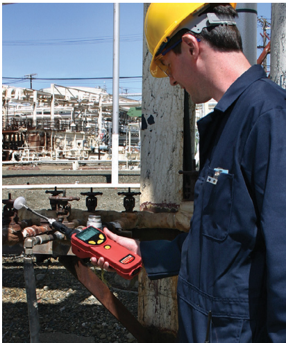
Werkers kunnen overal op de locatie VOC-metingen snel en eenvoudig verkrijgen met RAE Systems UltraRAE 3000+
