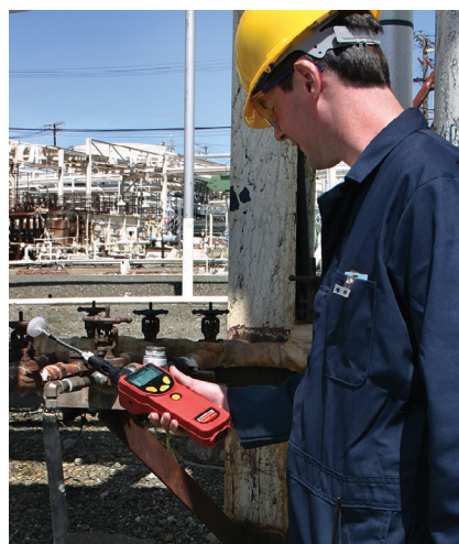
Os operadores podem obter leituras de COV de forma fácil e rápida em qualquer local das instalações com o UltraRAE 3000+ dos Sistemas RAE
