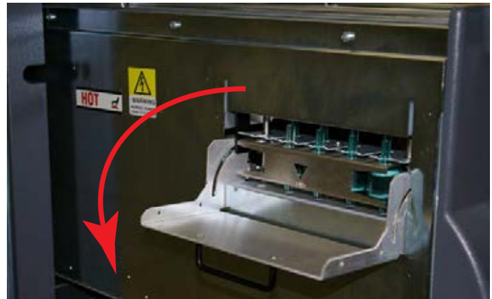
Pyrolyzer Filter Door
