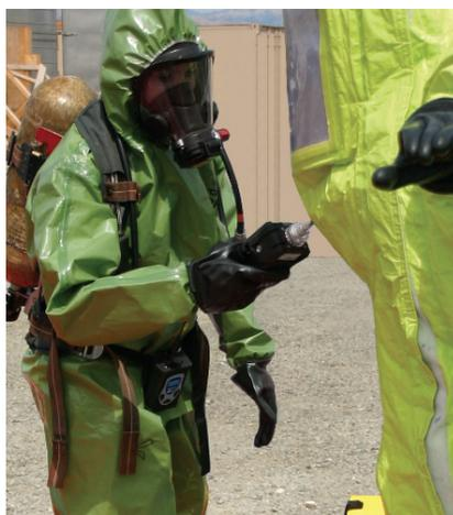
Быстрое измерение содержания летучих органических веществ и передача показаний по беспроводной связи на расстояние до 3 км.
