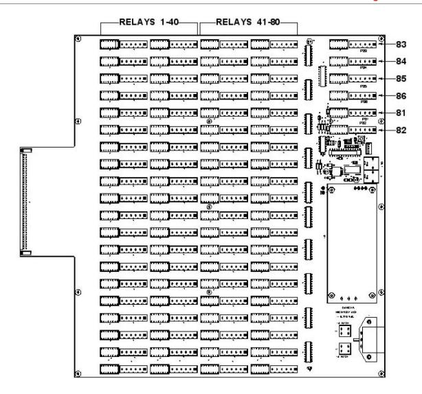
Figure 28. Relay Output Wiring
