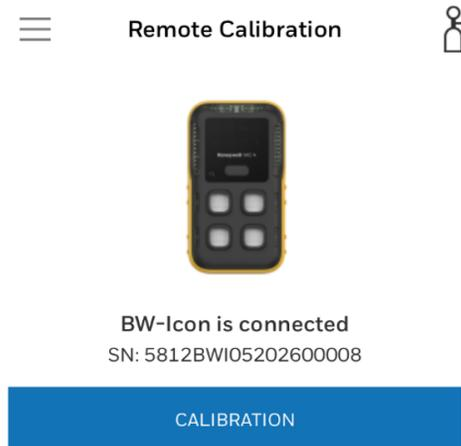
8. Introduzca el nombre del operador en **Nombre del operador** y, luego, toque **COMENZAR**. El instrumento comenzará la calibración a cero. IntelliFlash parpadeará en color ámbar y el
