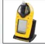
Kiinteä pumppu ja paristolaturi
