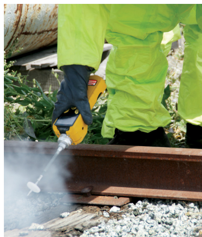
I dipendenti possono misurare rapidamente le sostanze chimiche organiche volatili e trasmettere i dati in modalità wireless
