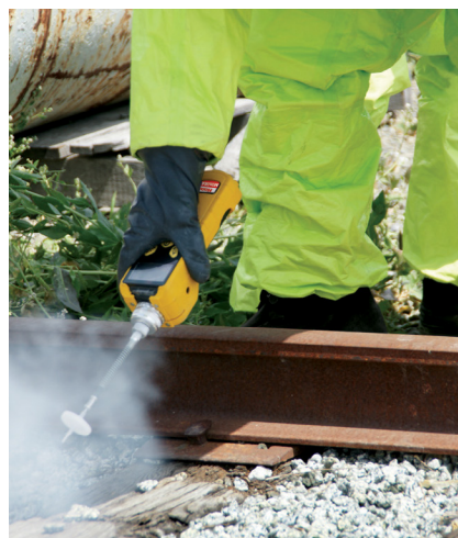
Os operadores podem medir COV rapidamente e transmitir dados através de uma ligação sem fios
