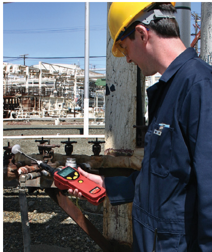
Los trabajadores pueden obtener lecturas de COV rápidas y sencillas en las instalaciones con el RAE Systems UltraRAE 3000+
