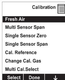
타이머 카운트다운 후 영점 교정이 완료됩니다. LCD에 센서 이름이 표시되고 각 교정의 완료 또는 실패 여부와 센서 측정값을 알려줍니다.
