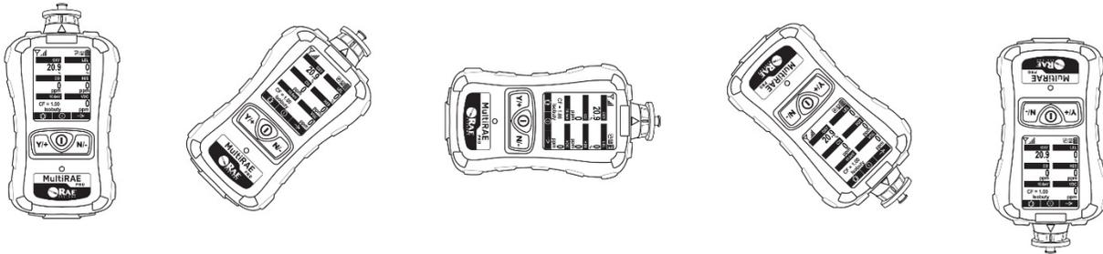
Conforme o MultiRAE for inclinado, o sensor de gravidade detecta sua orientação e inverte a tela quando ela passa de sua posição horizontal.
