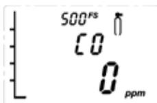
6. Dès que la mesure du gaz zéro est stable, ciblez '✓' pour confirmer l'étalonnage du zéro.
