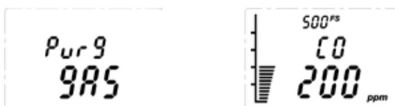
19. Coupez rapidement l'arrivée de gaz d'étalonnage et retirez le capuchon de gazage XCD du capteur afin que le gaz se disperse.
