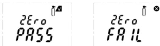
8. Coupez l'arrivée d'air provenant de la bouteille, le cas échéant. L'étalonnage du zéro est terminé et enregistré.
