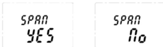
10. Pour étalonner le point de consigne dynamique, ciblez '✓' et passez à l'étape suivante. Si cet étalonnage n'est pas nécessaire, ciblez '▲▼' pour choisir « No » (non), puis '✓' pour revenir au mode de configuration.
