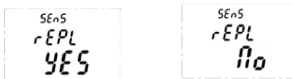
16. Avec les commutateurs '▲▼', sélectionnez « YES » si le capteur a été remplacé ou « No » dans le cas contraire.
