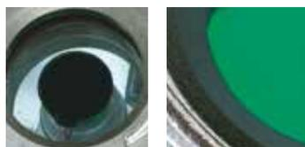
Éléments chauffants symétriques intégrés aux fenêtres de l'émetteur et du récepteur.
