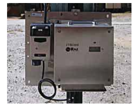
PowerPak verbonden met MeshGuard-monitor. Monitor wordt getoond in beschermende roestvrijtalen behuizing, beveiligd met bijgesloten hardware.
