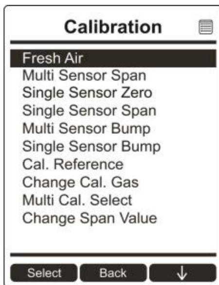
Après un compte à rebours, l'étalonnage du zéro est effectué. L'écran LCD affiche les noms des capteurs et vous indique si chaque étalonnage a réussi ou échoué, suivi des lectures des capteurs.
