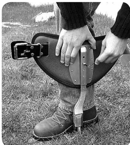
Ledernen Wadenschutz am Gestell festschrauben (für einen optimalen Halt, Schraube mit größtmöglichen Abstand platzieren)
