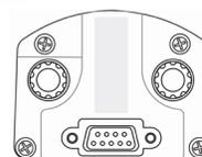
**Observação:** antes de conectar o carregador ao instrumento, inspecione visualmente os contatos para certificar-se de que estejam limpos. Se não estiverem, limpe-os com um pano macio. Não use solventes ou produtos de limpeza abrasivos.
