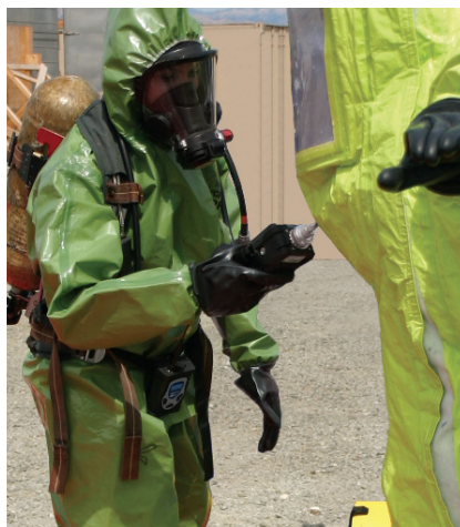
Arbeiter können VOCs messen und Messwerte drahtlos bis zu 3 km weit übertragen.
