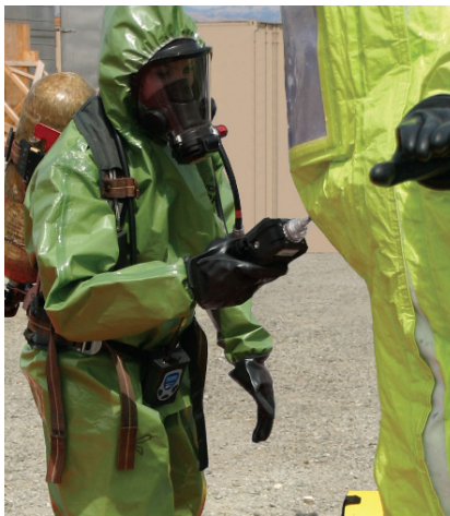
Los trabajadores pueden medir los COV fácilmente y transmitir las lecturas a hasta 2 millas/3 km de distancia.
