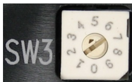
Figura 3-3 SW3 Chave giratória de dez (10) posições
