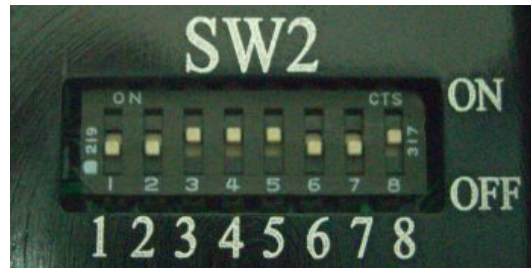
Chave DIP de oito (8) posições (SW2) - Figura 3-2
