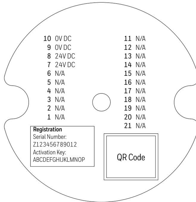
Figura 28. Etiqueta dos conectores dos terminais do transmissor
